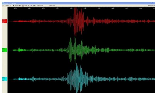
Fig. 10. Sismograma del terremoto de Costa de Maule, Chile, de 27/02/2010, de magnitud 8.8  $M_w$ , registrado en el sismógrafo de banda ancha de la Universidad de Jaén. Las ondas superficiales son las que predominan en el registro. De arriba a abajo: componentes NS, vertical y EW. Ventana de tiempo que se muestra: aprox. 107 min.
